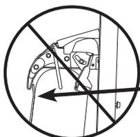
**Note: Aucune partie de l'appareil respiratoire ARI (châssis, tuyaux, etc.) ne doit se trouver à l'intérieur de la pince.**
